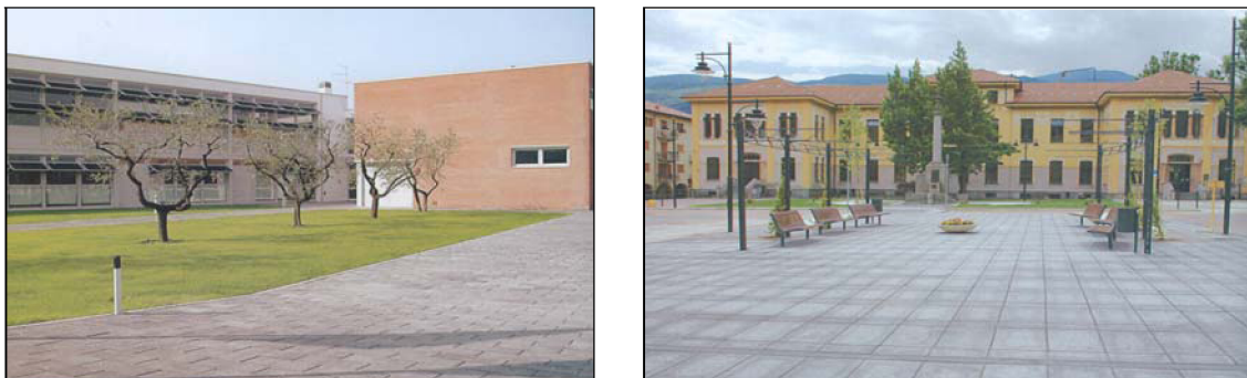
Figura 3 - Esempi di pavimentazione in masselli autobloccanti di cls
